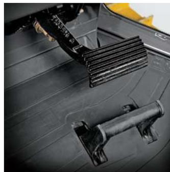
Elija la función de decelerador adecuada para el trabajo. Reduzca la velocidad de desplazamiento y las r. p. m. del motor, o solamente la velocidad de desplazamiento para mantener la tracción sin afectar la potencia del motor y la respuesta del sistema hidráulico. Si se presiona totalmente el pedal, se accionan los frenos.
