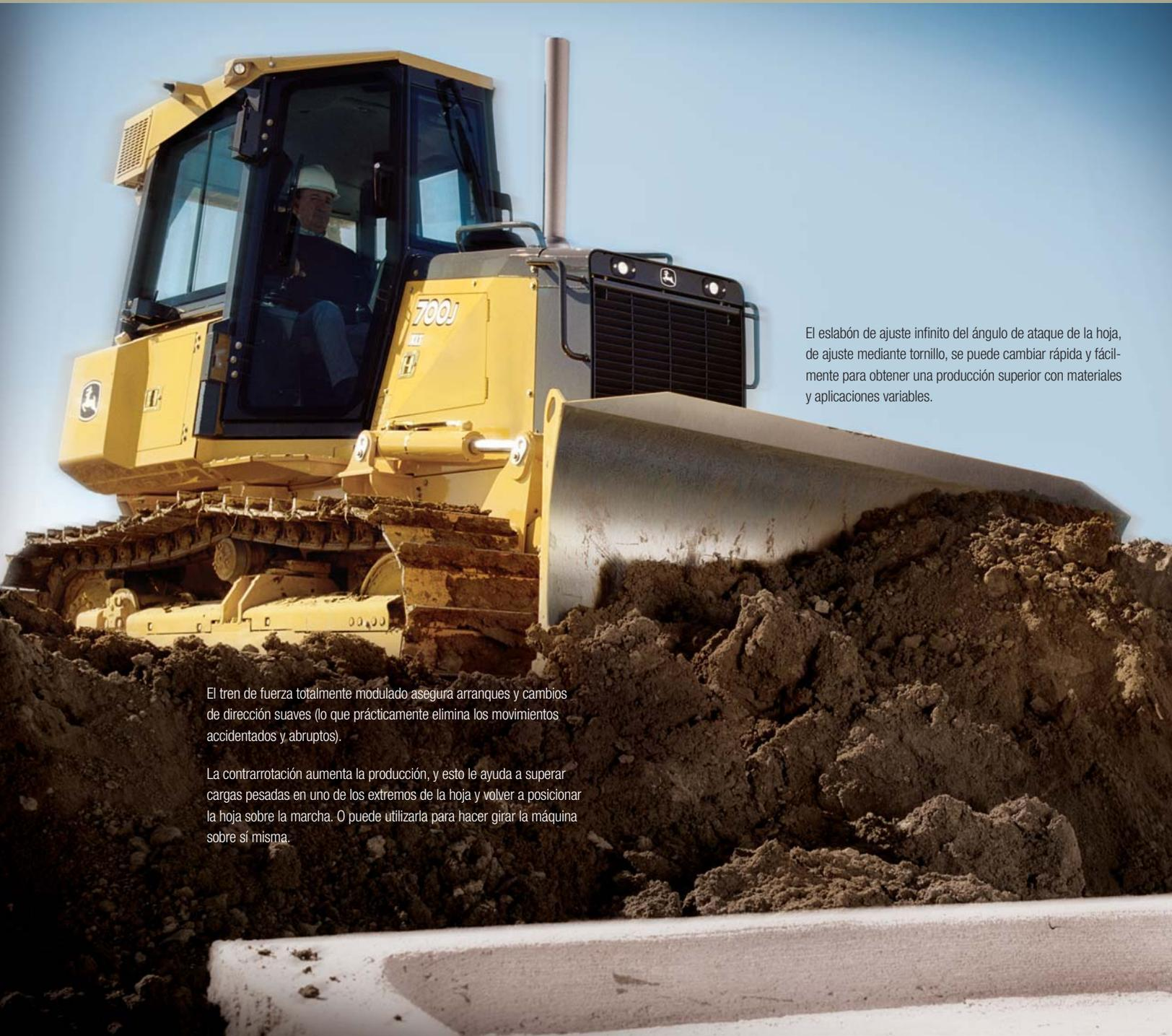
El eslabón de ajuste infinito del ángulo de ataque de la hoja, de ajuste mediante tornillo, se puede cambiar rápida y fácilmente para obtener una producción superior con materiales y aplicaciones variables.
