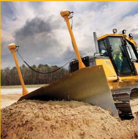
Cuando se equipa con el paquete opcional de control integrado de navegación (IGC, Intergrated Grade Control), el tractor topador llega desde la fábrica listo para conectar y funcionar. El diseño de arquitectura abierta le permite utilizar el sistema de control electrónico de nivelación adecuado para usted.
