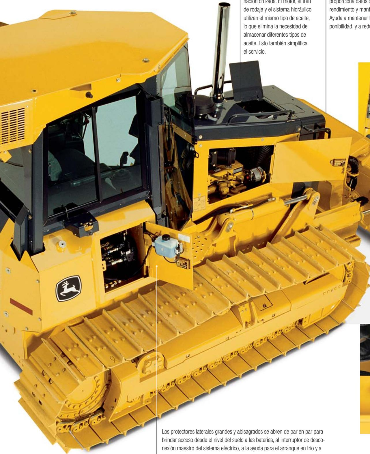
Los depósitos hidráulicos e hidrostáticos separados eliminan cualquier posibilidad de contaminación cruzada. El motor, el tren de rodaje y el sistema hidráulico utilizan el mismo tipo de aceite, lo que elimina la necesidad de almacenar diferentes tipos de aceite. Esto también simplifica el servicio.
