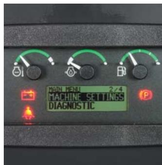
La personalización del funcionamiento de la máquina puede realizarse fácilmente mediante el monitor. El monitor TMC le permite realizar un ajuste preciso del modo y la respuesta del decelerador, las gamas de velocidad de avance y marcha atrás, la modulación de la dirección y las relaciones de las marchas de avance y marcha atrás. Para brindar un control sin igual.
