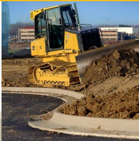
El control de velocidad infinitamente variable de las cadenas le permite aumentar o reducir la potencia de cualquiera de las dos cadenas, lo que permite realizar giros de potencia alta suaves, que no quitan potencia del motor ni rompen los terrenos blandos.
