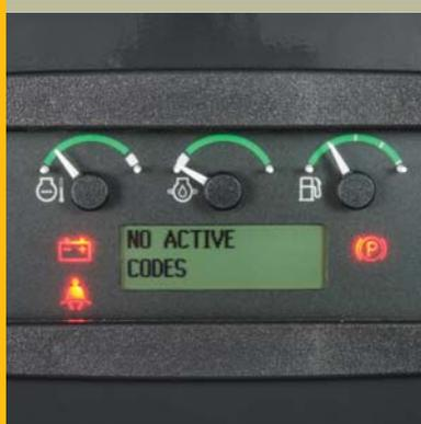
A diferencia de otros tractores topadores que requieren el uso de una computadora portátil, el monitor de diagnóstico avanzado proporciona mensajes fáciles de entender.
