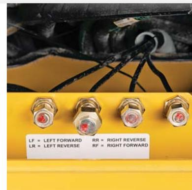
Los puertos de prueba remotos y los mensajes de diagnóstico permiten a los técnicos solucionar rápidamente los problemas.
