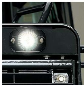
Las luces de manejo halógenas de intensidad alta forman parte del equipo estándar. Además, puede optar por el paquete de luces de 360° instalado en la fábrica que brinda una iluminación superior para el trabajo nocturno.
