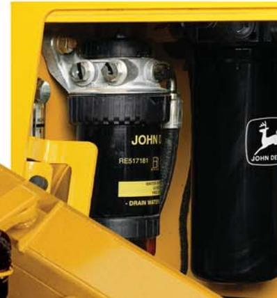
Los protectores laterales grandes y abisagrados se abren de par en par para brindar acceso desde el nivel del suelo a las baterías, al interruptor de desconexión maestro del sistema eléctrico, a la ayuda para el arranque en frío y a los filtros verticales de la transmisión, del sistema hidráulico y de combustible.
