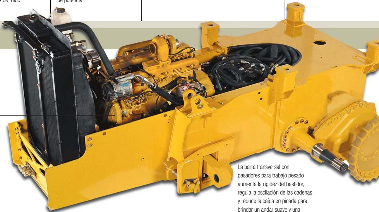
La barra transversal con pasadores para trabajo pesado aumenta la rigidez del bastidor, regula la oscilación de las cadenas y reduce la caída en picada para brindar un andar suave y una capacidad de nivelación mejorada.
