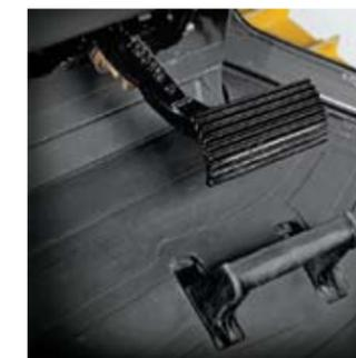
Escoja la función del desacelerador que mejor se adapte a su trabajo. Aminorare las velocidades de avance y del motor, o solamente la de avance para ayudar a conservar la tracción sin afectar ni la potencia del motor ni la respuesta hidráulica. Al pisar a fondo el pedal se aplican los frenos.
