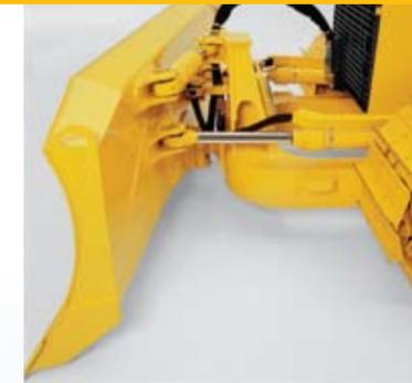
El diseño de celda cerrada de la hoja topadora PAT y el bastidor con sección en C aportan resistencia y durabilidad excepcionales. Las vigas de empuje de montaje exterior son igualmente duraderas.
