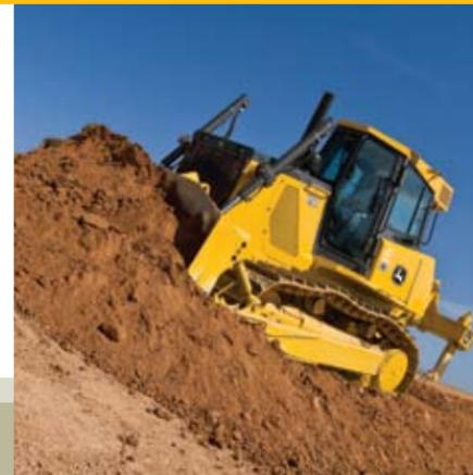
Los controles que gobiernan la hoja y el tren de mando hidrostático con capacidades plenas requieren poco esfuerzo para asegurar una respuesta previsible en todo momento y en todas condiciones.
