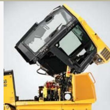
El puesto del operador puede inclinarse hasta 70 grados en cuestión de minutos para obtener acceso a los componentes internos. A diferencia de otros tractores sobre orugas, no es necesario desconectar varillajes, conductos hidráulicos ni alambres.
