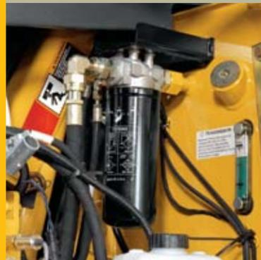
Los filtros verticales permiten hacer los cambios con rapidez y sin derrames. El motor, el sistema hidráulico y la transmisión utilizan un aceite común, simplificando aun más el mantenimiento.
