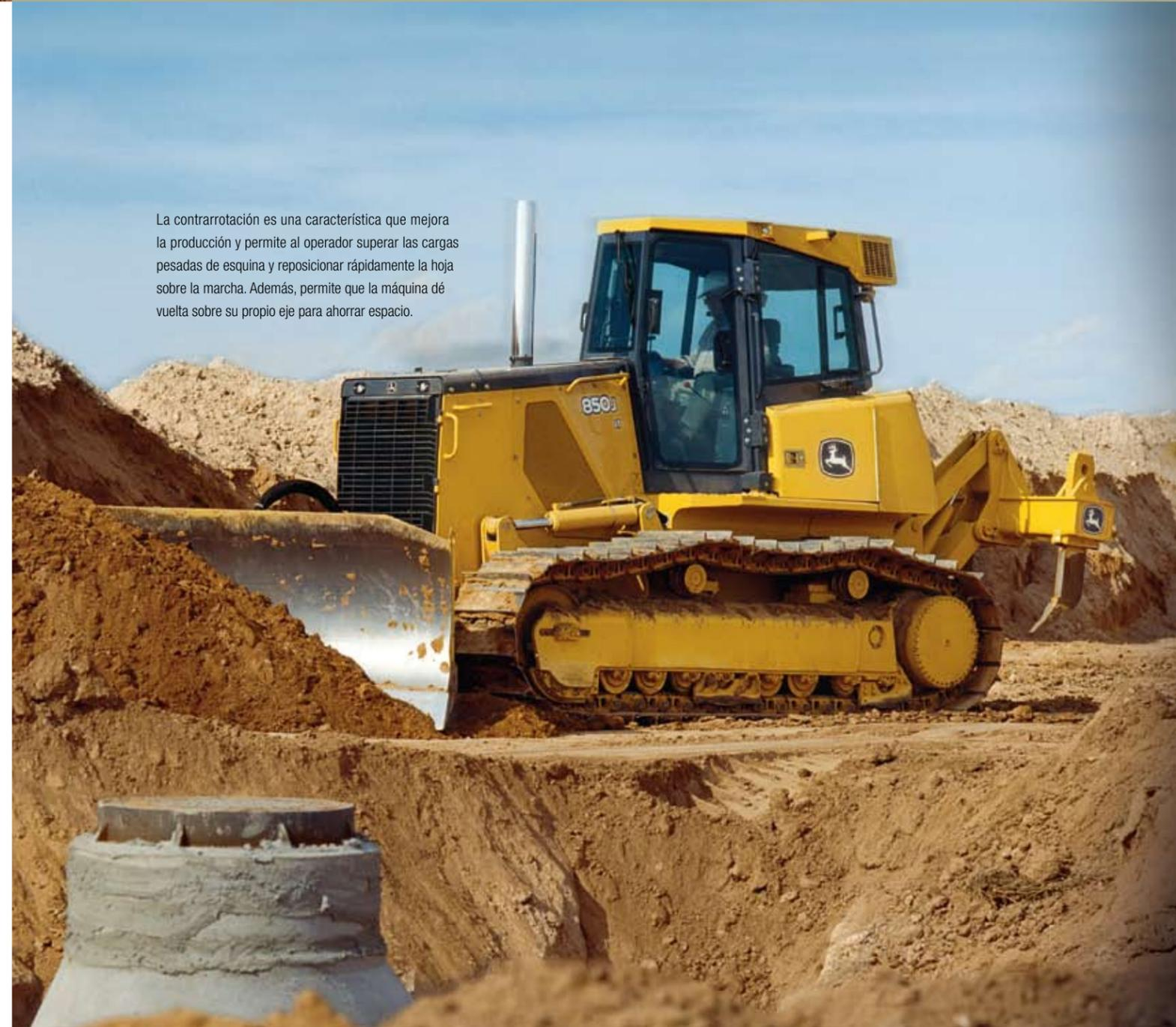
La contrarrotación es una característica que mejora la producción y permite al operador superar las cargas pesadas de esquina y reposicionar rápidamente la hoja sobre la marcha. Además, permite que la máquina dé vuelta sobre su propio eje para ahorrar espacio.
