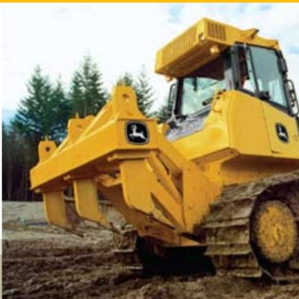
El tren de mando sumamente adaptable de las máquinas de la serie J las hace ideales para trabajar con accesorios de montaje trasero tales como desgarradores y arados para cable.
