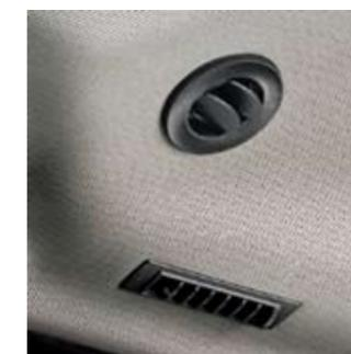
Las persianas tipo automovilístico entregan un flujo de aire eficaz para mantener el cristal desempañado y la cabina cómoda. El acondicionador de aire es estándar en todas las cabinas. Para las máquinas sobre orugas con ROPS solamente, un calefactor opcional instalado debajo del asiento mantiene abrigado al operador.
