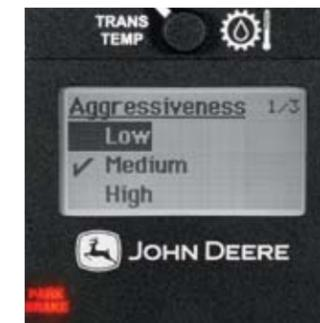
El exclusivo sistema TMC permite ajustar el modo y respuesta del desacelerador, las gamas de marchas de avance/retroceso, la modulación de la dirección, el ritmo de cambio de sentido de marcha y las relaciones de velocidades de avance/retroceso para ofrecer un control inigualado.
